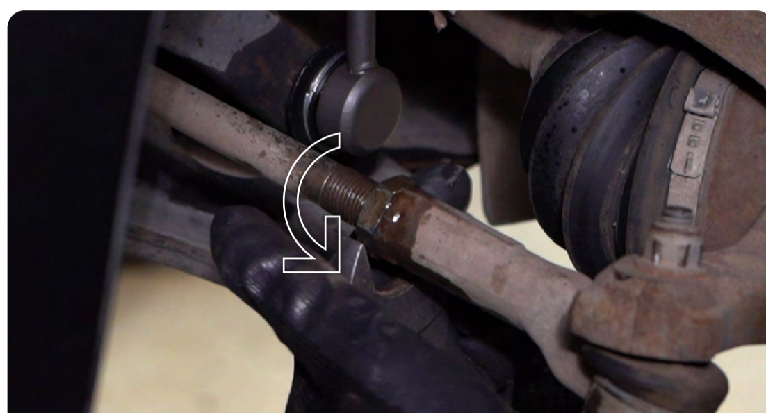
4 | Aflojá la contratuercas del extremo de dirección.
