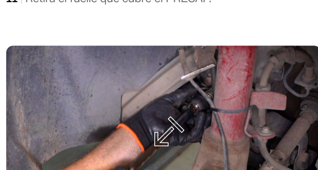
13 | Retirá el PRECAP dañado.
