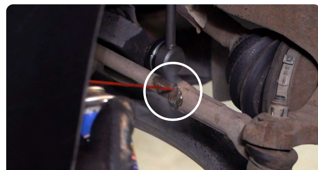
3 | Lubricá con aceite la contratuercas del extremo de dirección.
