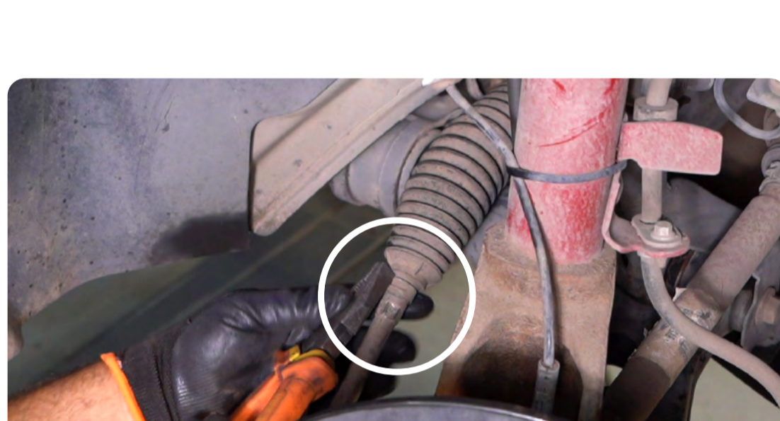
10 | Retirá las abrazaderas que sostienen el fuelle.
