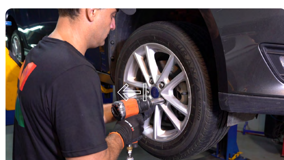
1 | Afloja y retirá las tuercas de la rueda. Luego retirá la rueda del vehículo.
