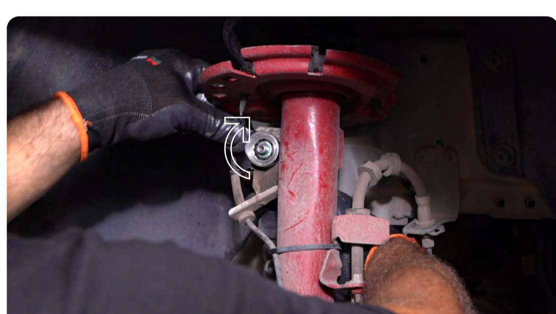
12 | Ajustá las tuercas autofrenantes en la nueva bieleta.
