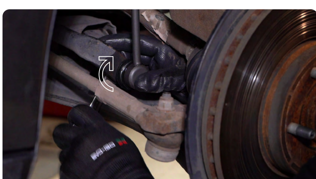
13 | Ajustá la contratruca del extremo de dirección.
