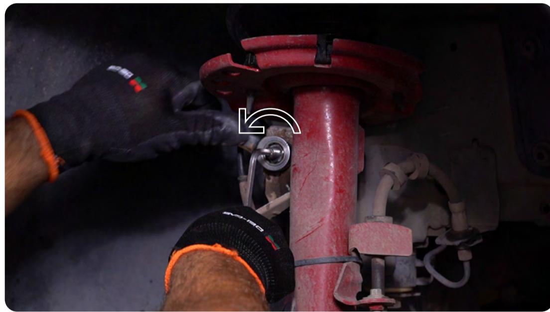
4 | Aflojá la tuerca frontal de la BIELETA.
