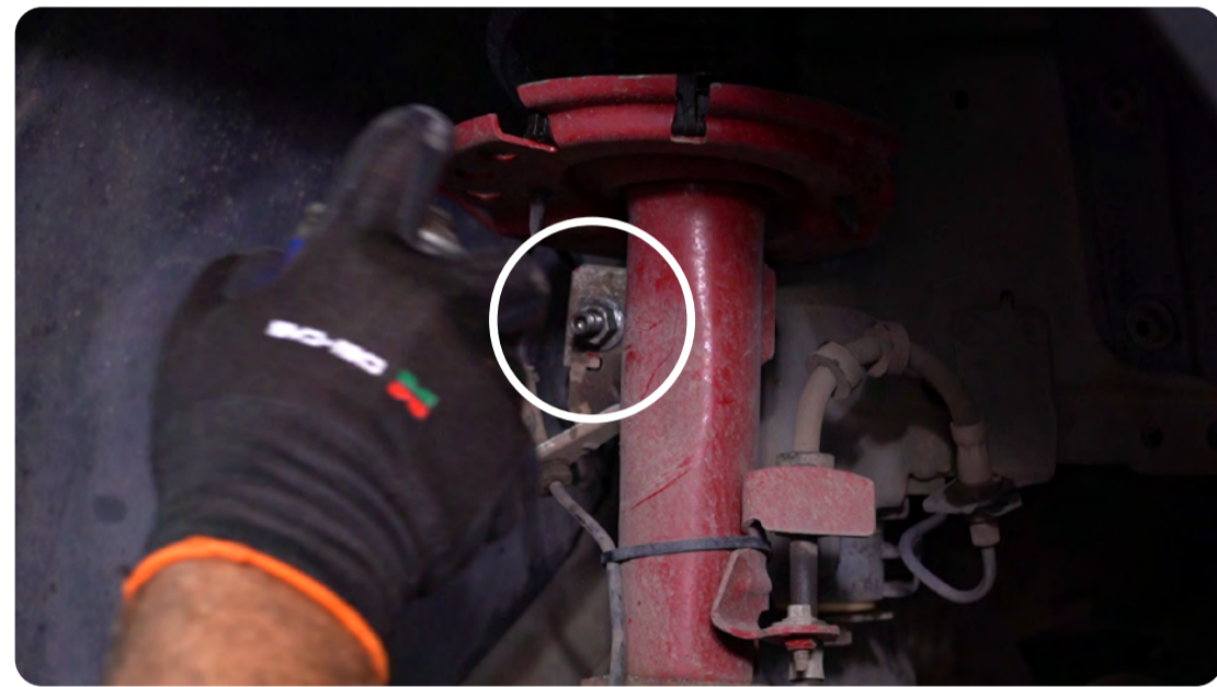
3 | Lubricá con aceite la tuerca frontal de la BIELETA.
