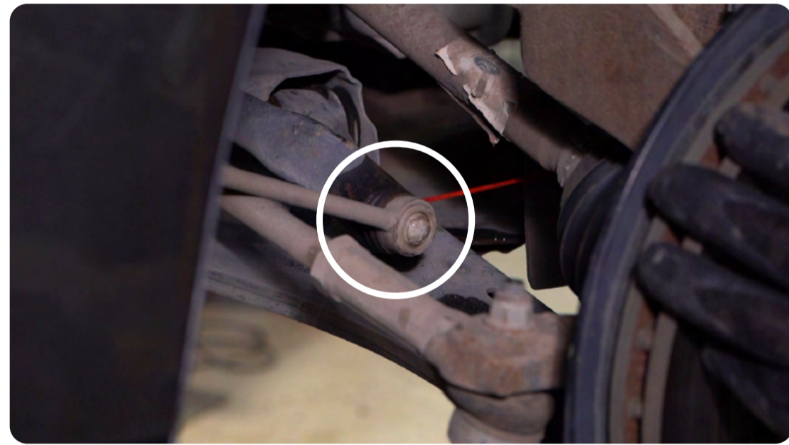
7 | Lubricá con aceite la otra tuerca de la BIELETA.
