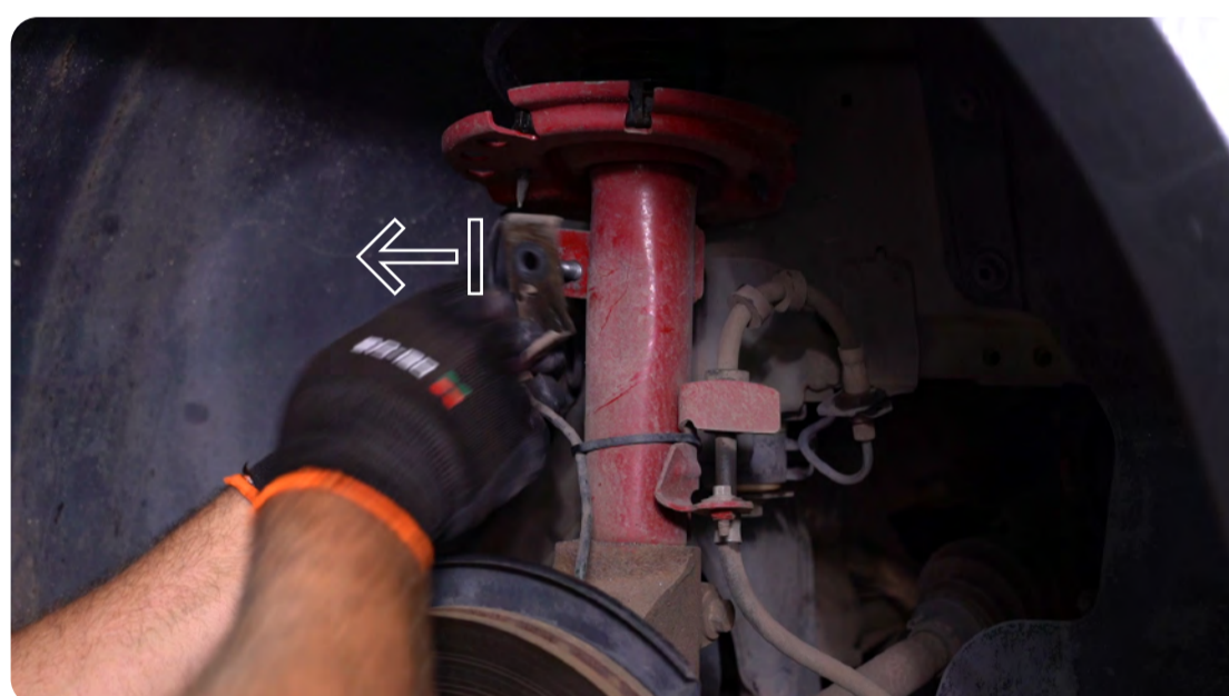
6 | Desclavá la parte superior de la BIELETA.
